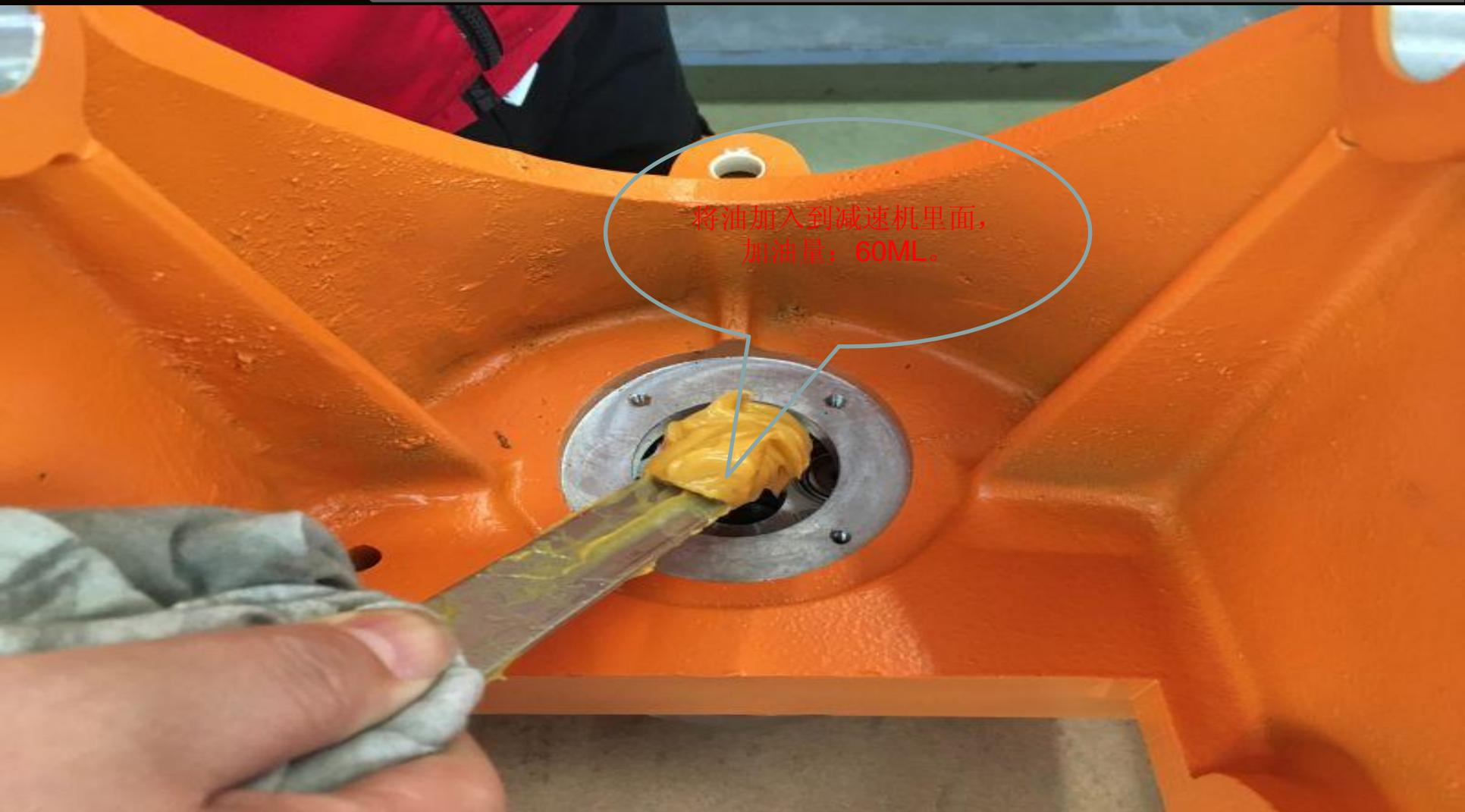
将油加入到减速机里面，
