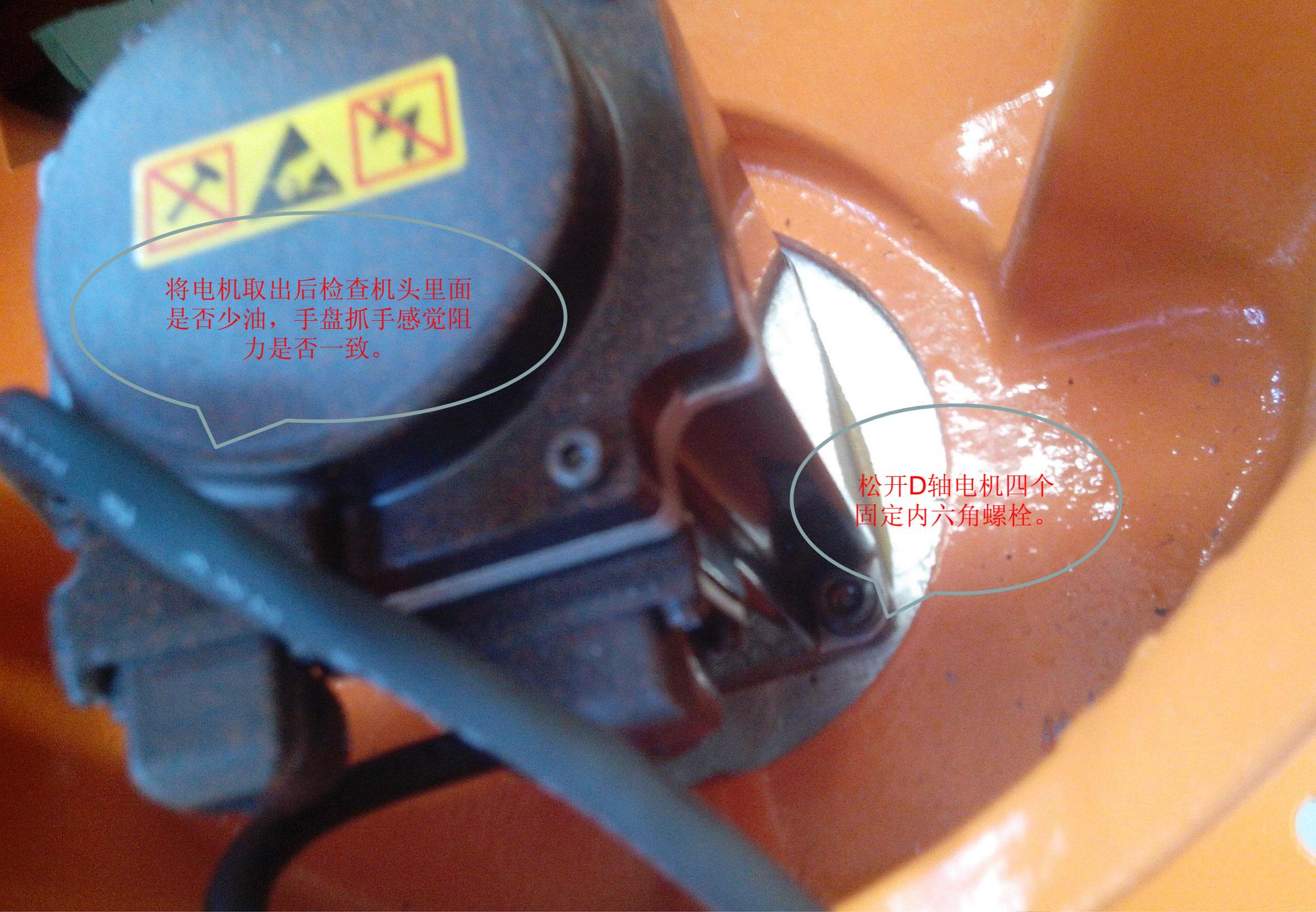
将电机取出后检查机头里面是否少油，手盘抓手感觉阻力是否一致。
